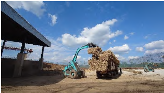
รถคืบก่อนใบอ้อยขนย้ายก่อนใบอ้อยจากรถบรรทุกบริเวณอาคารย่อยเชื้อเพลิง 4
