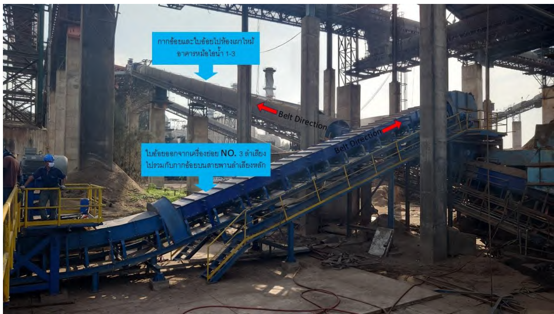
ตัวอย่างเส้นทางลำเลียงใบอ้อยไปรวมกับกากอ้อยบนสายพานลำเลียงเชื้อเพลิง
